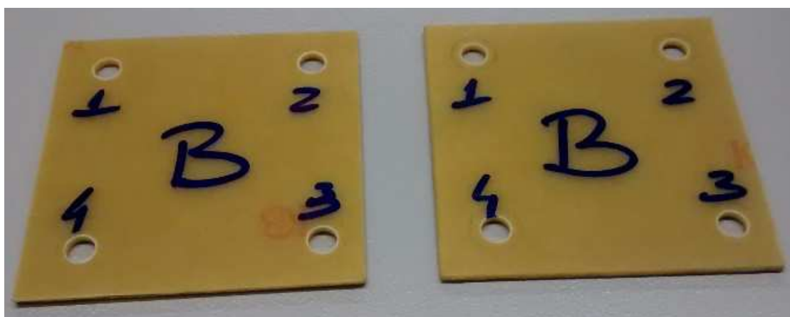
Figura 11 - Placas de fenolite 50x50mm
